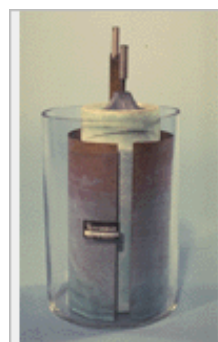
La pila Daniell con visibili gli elettrodi di zinco, di rame e il vaso poroso; nella immagine sotto lo schema di funzionamento: l'elettrodo di zinco si consuma insieme al solfato di rame; l'elettrodo di rame cresce e il solfato di zinco precipita
