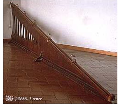
modello di piano inclinato con cui Galilei studiava il moto uniformemente accelerato
