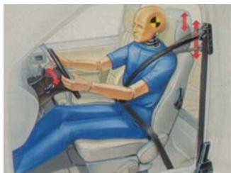
airbag e cinture di sicurezza: due protezioni basate sull'aumento di  $\Delta t$  che, a parità di impulso, fa diminuire la forza di interazione
