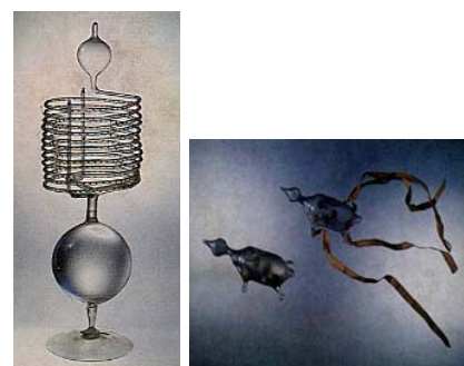
a sinistra termometro ad alcool della Accademia del Cimento in grado di apprezzare oltre 400 divisioni; a destra termometri clinici a forma di rana da applicare al polso
