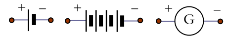
I simboli utilizzati per rappresentare l'elemento di una pila, la batteria di pile e un generico generatore di tensione
