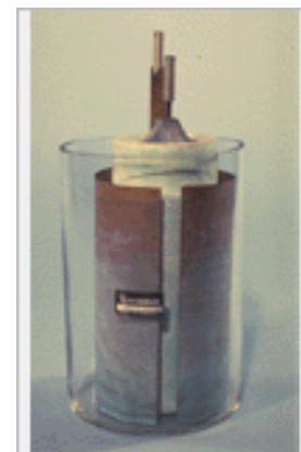
La pila Daniell con visibili gli elettrodi di zinco, di rame e il vaso poroso; nella immagine sotto lo schema di funzionamento: l'elettrodo di zinco si consuma insieme al solfato di rame; l'elettrodo di rame cresce e il solfato di zinco precipita
