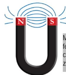
Magnete permanente a ferro di cavallo: se si avvicinano i poli si può realizzare un campo uniforme
