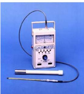
Misuratore di campo magnetico basato sull'effetto Hall; la sonda è percorsa da una corrente nota e viene preventivamente tarata attraverso un campo noto; a questo punto dalla misura di  $\Delta V$  si risale alla misura del campo magnetico in cui viene immersa la sonda
