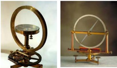
Bussola delle tangenti del 1840 con a lato la bussola necessaria alla individuazione del meridiano magnetico; si tratta di uno dei primi strumenti di misura di grandezze elettriche costruito
