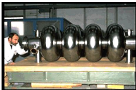
le cavità risonanti superconduttrici usate per aumentare l'energia del fascio; le cavità sono distribuite lungo l'intero percorso e devono applicare sincronicamente l'impulso di campo elettrico al momento giusto
