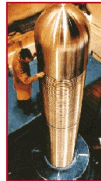
il generatore di Van der Graaf è la macchina elettrostatica in grado di produrre la massima d.d.p.: lo si usa come primo stadio negli acceleratori a più stadi
