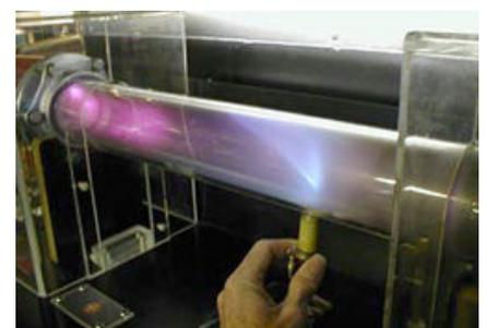
Un magnete piega ortogonalmente la velocità di un fascio di elettroni in un tubo a bassa pressione
