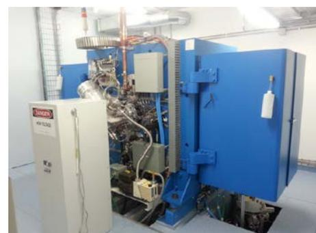
Un esempio di ciclotrone ospedaliero per la generazione di isotopi radioattivi per la produzione di radiofarmaci
