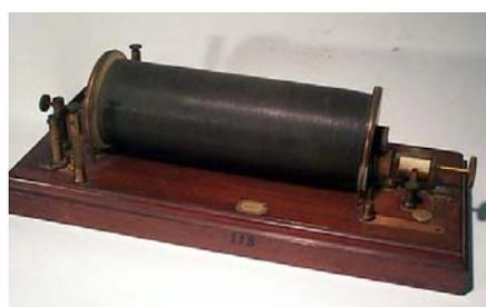
Nel rocchetto di Ruhmkorff si sfruttano il principio del trasformatore e quello del campanello per produrre d.d.p. unidirezionali molto elevate a partire dalla bassa tensione di una pila; questo strumento ha consentito la scoperta di molti fenomeni rivoluzionari a fine 800
