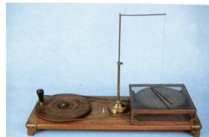
Il disco di Arago: un disco di rame, posto in rapida rotazione appare in grado di trascinare parzialmente un ago magnetico
