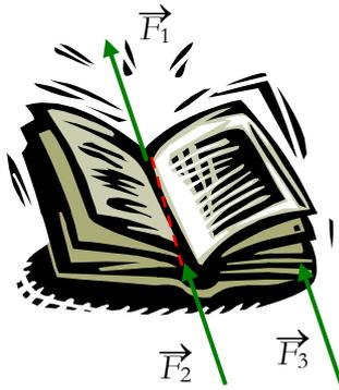
con semplici esperimenti sui corpi rigidi si osserva che se si cambia **retta di applicazione** senza cambiare la direzione si ottengono risultati diversi
