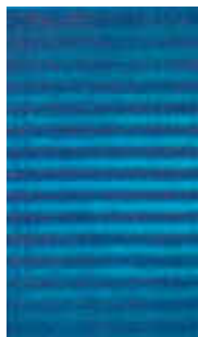
frange di interferenza in luce blu; la interferenza produce stazionarietà e richiede coerenza nelle sorgenti
