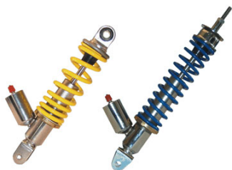
gli ammortizzatori vengono progettati per dar luogo ad un rapido processo di smorzamento e sfruttano solitamente l'attrito viscoso
