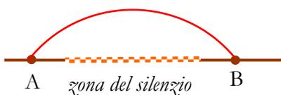
In base alla (IV.2.14) la velocità di propagazione del suono in aria è proporzionale a  $\sqrt{T}$  e pertanto se per qualche ragione si determina un gradiente termico positivo la velocità di propagazione cresce con la quota e le onde sonore tendono a disporsi come in figura per effetto della *rifra-*
