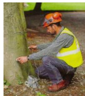
diagnostica dello stato di salute di un tronco con uno strumento ad ultrasuoni che registra variazioni nella velocità di propagazione dovute a cavità; frequenza 77 kHz
