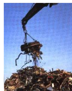
un elettromagnete utilizzato come organo di presa per lo spostamento di materiali ferrosi
